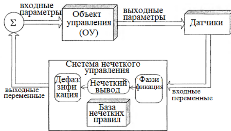
Рис. 2.10. Архитектура компонентов процесса нечеткого управления
